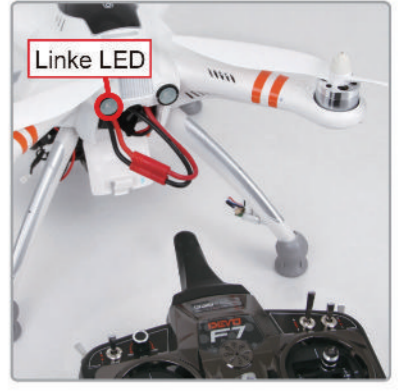
5.4 Linke LED blinkt bis der Bindevorgang erfolgreich ist
