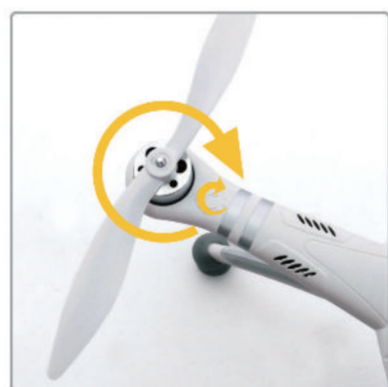
2.2 Propeller gemäß Richtungsangabe (Pfeile) anbringen
