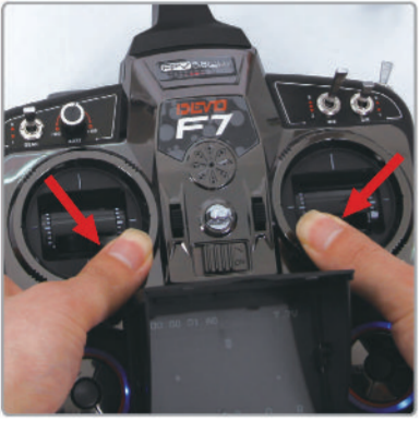
6.1 Kalibrierung durch Stickbefehl einleiten
