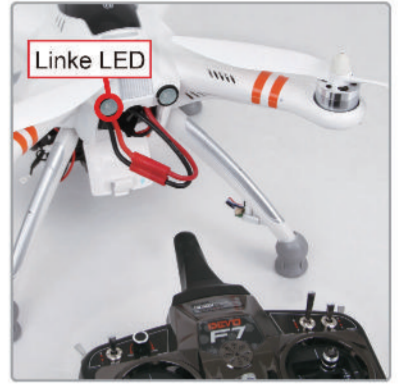
6.6 Linke LED blinkt während der Kalibrierung schnell. Nach der Kalibrierung geht sie aus. Den Kopter anschließend vom Strom trennen.
