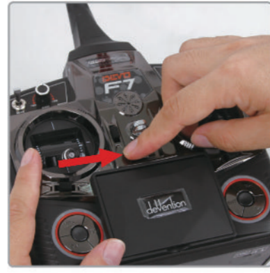
5.2 Alle Schalter sowie Gasknüppel in die Position 0 bringen, dann den Sender einschalten
